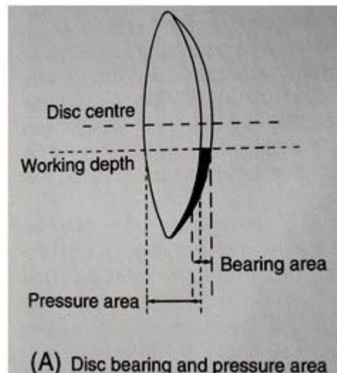
**Fig. 4 Disc Bearings**
